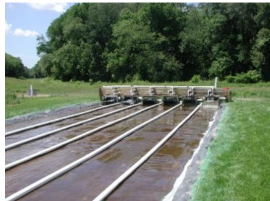
Figur 2. Til venstre ses solcellerne der driver pumpen til cirkulation af drænvandet ovenpå gummipladerne (billede højre) (Kangas & Mulbry, 2014b).
